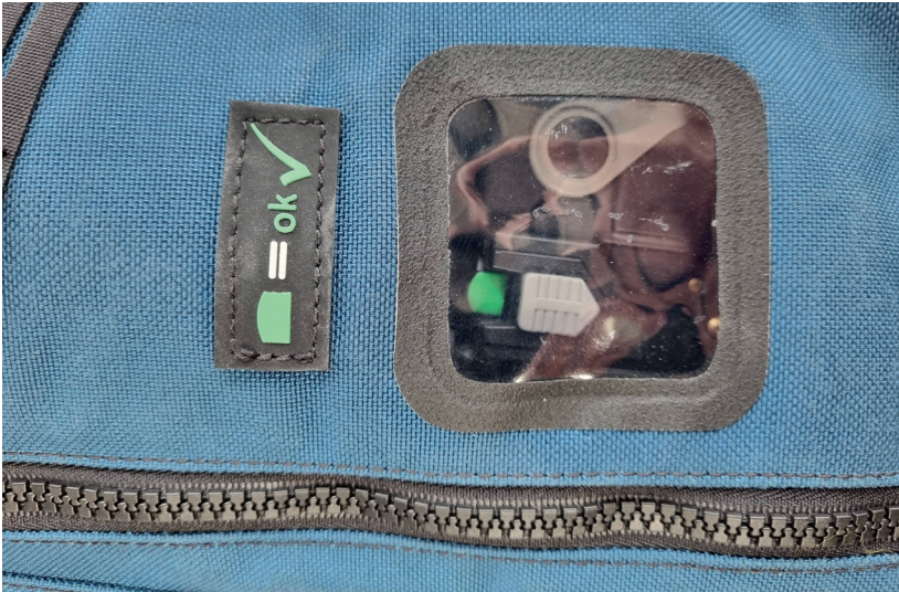
Abb. 15: THW Rettungsweste „Sierra 300“ – Prüfung der Funktionstüchtigkeit
